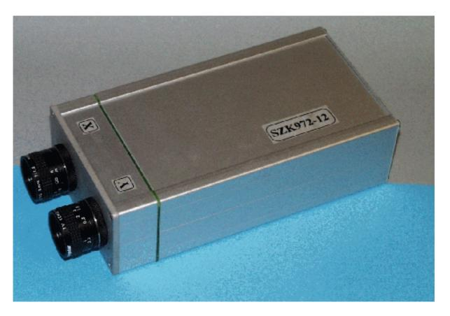
Stereo-Zeilenkamera mit hoher Dynamik und integrierter Verarbeitungseinheit
