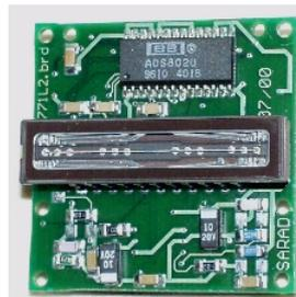
Zeilensensor 2048 x 14µm
